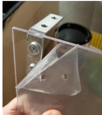
Abb. 6 & 7: Die Winkel, die die 2 Scheiben zusammenhalten
