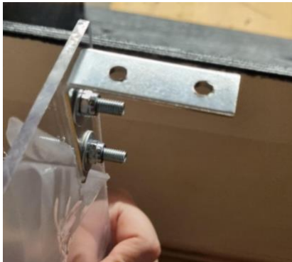
Abb. 6 & 7: Die Winkel, die die 2 Scheiben zusammenhalten
